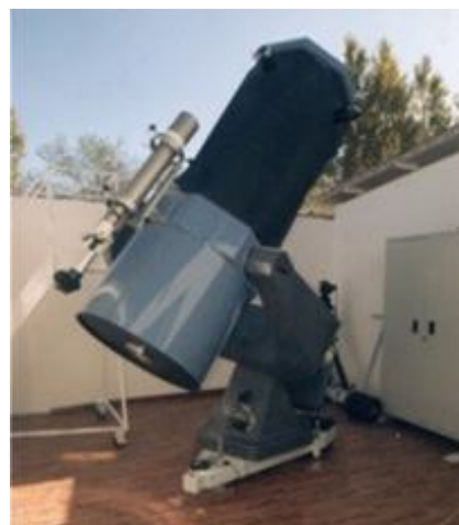
L'Osservatorio di Cervarezza Terme e, sotto, il telescopio di 60cm, f/3.6, costruzione Reginato.
