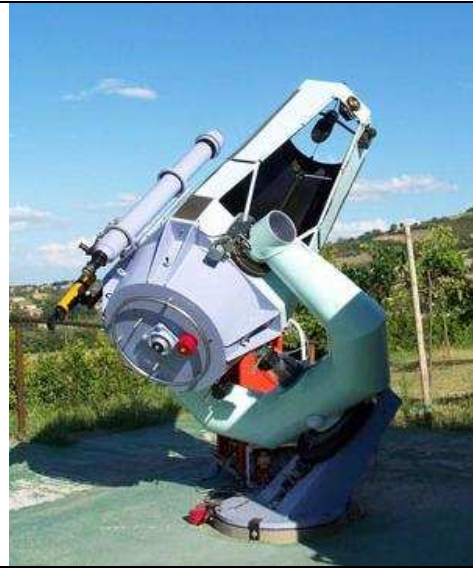
Il riflettore di 61 cm, f/4.5, di Guido Grazioli e Claudio Bertozzi , collocato a Iano di Scandiano. Abilissimi costruttori, i due non sono ancora stati “arruolati”. Il telescopio è molto bello ed ha potenzialità notevolissime. Bisognerebbe poterlo testarlo su Urano.
